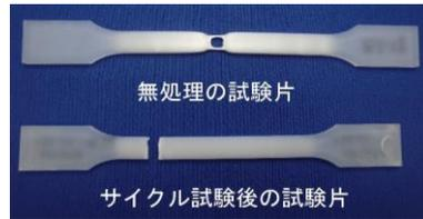
引張試験後の比較結果
