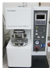
上：高圧破裂試験機
