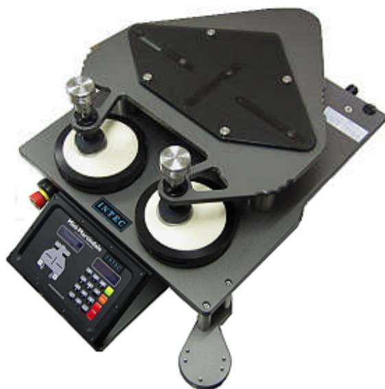
図1 マーチンデル磨耗試験機（インテック(株) 型式：902）
