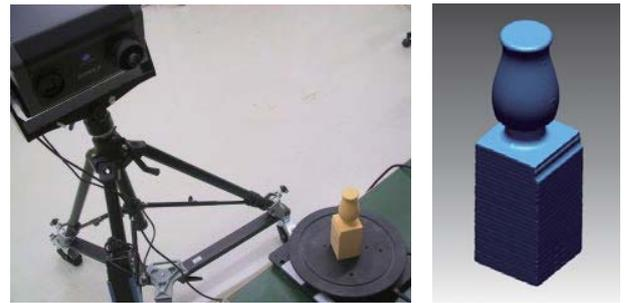
非接触三次元計測システムと測定例
