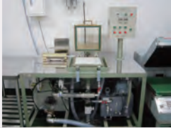
角形タッピングマシン(吸引タンク付) No.2555 熊谷理機工業(株)
