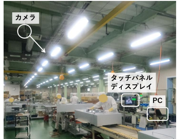
図3 システムを配置した作業現場の様子
