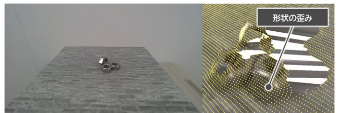
D405で取得したM5ナットの画像(左)と3D点群(右)
