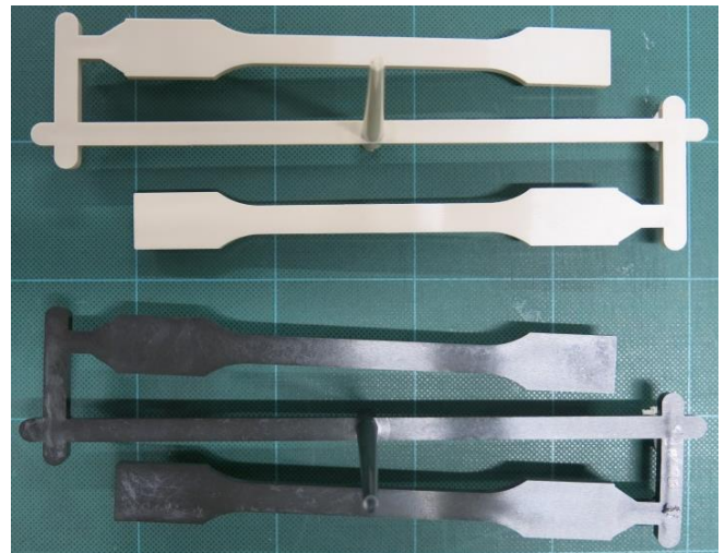
図4 射出成形品の写真 (上: PEEK樹脂 下: PEEK+CF樹脂)
