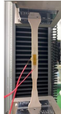
図11 引張試験におけるネッキングの様子 (PEEK樹脂)
