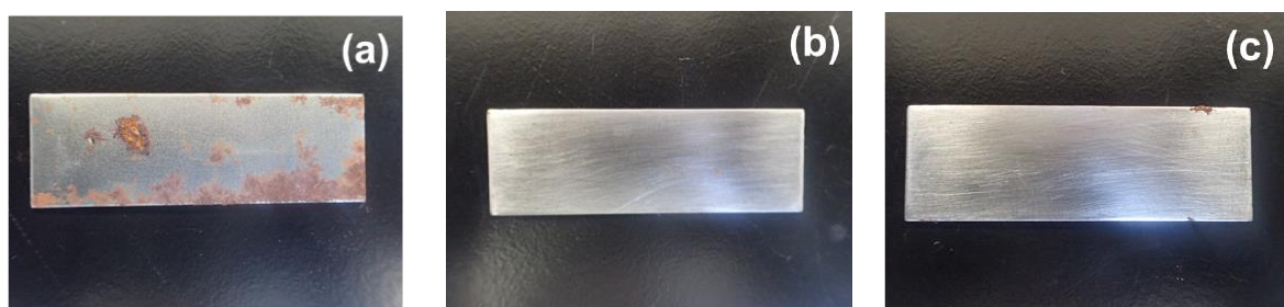
図2 25°Cにおける相対湿度97%RHになるように調整したデシケーター内に約1年間静置した各基板の外観画像 (a)未処理、(b)PFDPA処理、(c)UDPA処理
