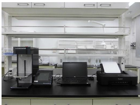
食物物性測定装置 用途：食品の物性（粘弾性等）の計測 メーカー：サン科学（株）レオメーター
