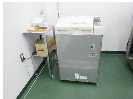
小型レトルト殺菌装置 用途：レトルト食品・缶詰等の試作 メーカー：パナソニック（株） 達人釜
