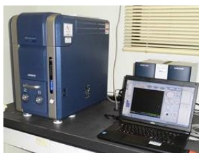
低真空電子顕微鏡（卓上型、元素分析機能付き） (株)日立ハイテクサイエンス TM3030
