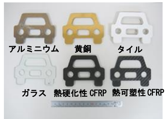
図 3 ウォータジェット加工機を使用した切断サンプル
