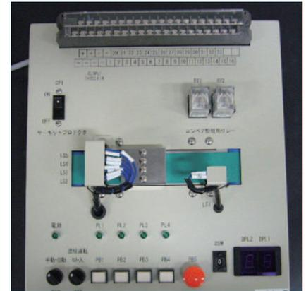
コンベアを往復させる制御回路
