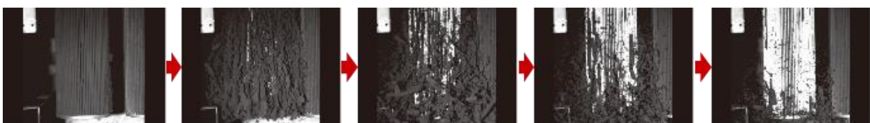
図 クリーニングによりフィルターから粉じんが脱落する様子 高速度カメラ画像（2000fps）
