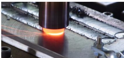
図1 超硬ツールによるFSPの様子
