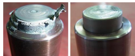
図5 使用後のツール外観、(左)超硬、(右)サーメット
